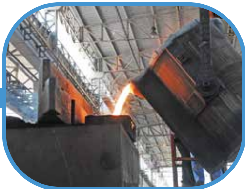
Magnesium Treatment & Pouring
